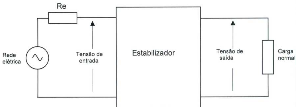
Figura 7 — Circuito elétrico utilizado na medição da regulação de saída com 90% de carga normal A regulação estática da tensão de saída calculada deve ser igual ou inferior ao declarado pelo fabricante.
