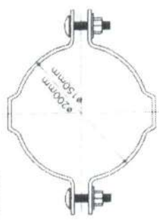
DET. CINTA (ABRACAÇADEIRA) ESCALA-1/6 25
