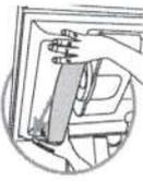
• Desencaxe o reservatório de água, levantando-o e puxando-o na sua direção conforme indicado na figura.
