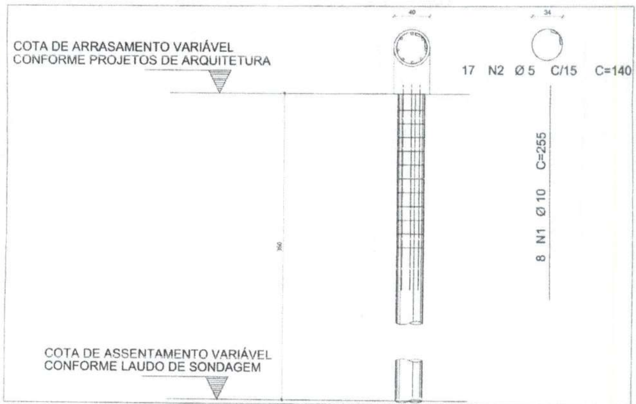
Figura 1-Detalhamento das estacas (3,50m)
